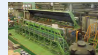
長尺めっき槽
