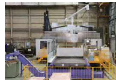
五面加工門型マシニングセンタ 最大加工寸法: 8,000L×3,050W×1,750H(mm)
