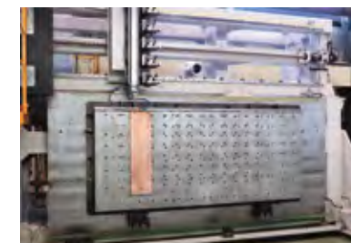
細深穴加工機 Φ1mm・最大1,000mmの細深穴が可能
