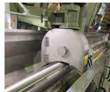
長尺研磨機 1号機 Φ600mm×全長8mの研磨が可能
