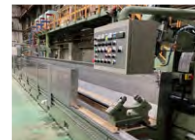
長尺研磨機 2号機 Φ350mm×全長10mの研磨が可能 湿式研磨、SF研磨対応可能なWヘッド型 素材の品種に関係なく、研磨施工が可能
