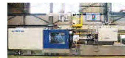
850t横型射出成型機(成形トライ用)
