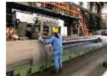
長尺ロール研磨機 2号機
