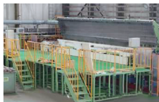
長尺ロールクロムめっき設備(10m槽) 最大φ500×全長9,600mm
