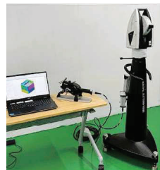
ライカレーザートラッカー式 非接触三次元測定システム
