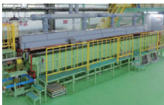
長尺ロールニッケルめっき設備(10m槽) 最大φ500×全長9,600mm
