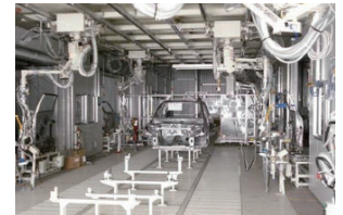
車体工場 (スラットCV)
