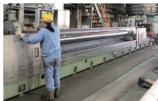
長尺ロール用研磨機 最大φ500×全長10,000mm
