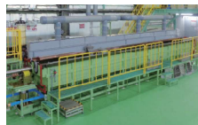
長尺ロールニッケルめっき設備(10m幅) 最大φ500×全長9,600mm
