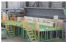
長尺ロールクロムめっき設備(10m幅) 最大φ500×全長9,600mm
