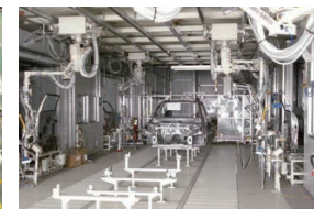
車体工場(スラットCV)
